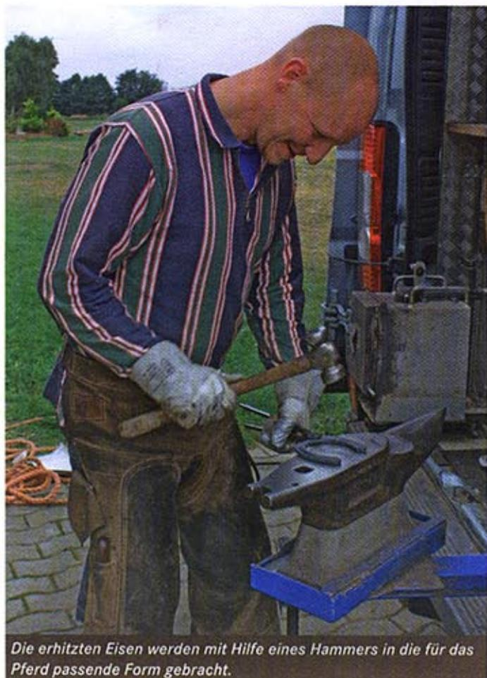
Die erhitzten Eisen werden mit Hilfe eines Hammers in die für das Pferd passende Form gebracht.
