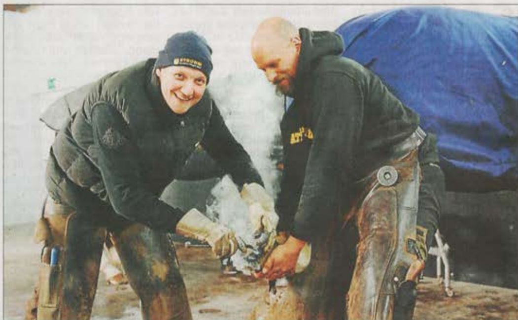
Da geht's heiß her: Hufschmied Dirk Fischer (li.) und sein Mitarbeiter beim Anpassen eines Hufeisens.
